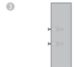
將螺絲釘插入孔中，並擰緊。直至只露出其1/4英寸長度。
