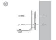
如圖所示，將掛牆托架和螺絲釘對準牆壁上的孔。請確保先把螺絲釘釘進中間的孔，以固定掛牆托架的位置，接著再將另一螺絲釘釘進頂部的孔。
