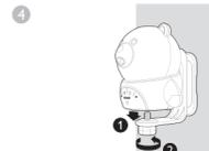
將嬰兒機放置在掛牆托架上，並將螺絲釘扭緊至底部的螺紋插口，以固定嬰兒機。
