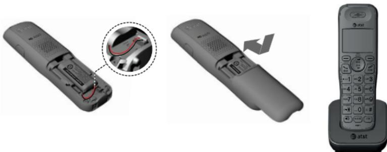
1. 把電池連接器穩固地插進電池蓋內的槽孔，然後插入隨產品提供的電池，標籤 **THIS SIDE UP** 向上，如圖所示。
