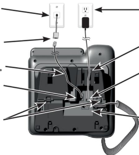
把座機電源變壓器線大的一端插入電源插座。
